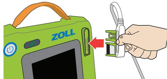
Branchez le connecteur du câble CPR Uni-padz sur le port d'électrode AED 3.
