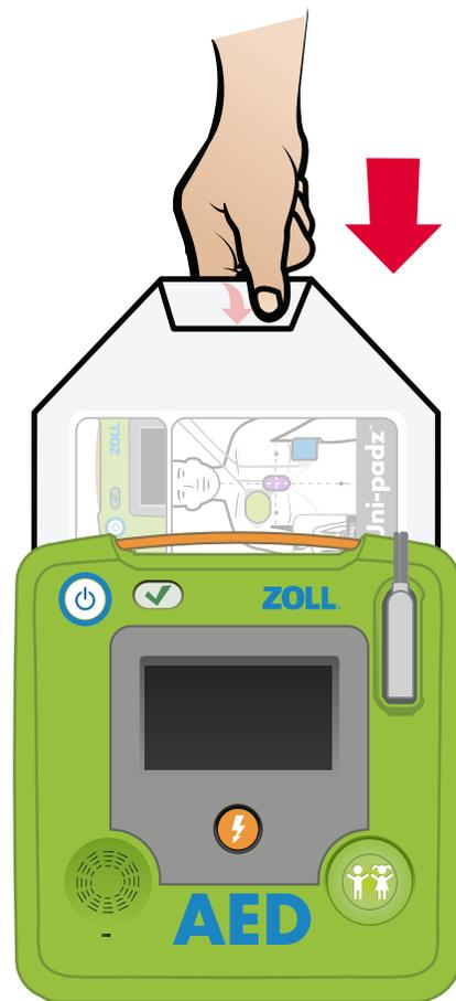
Le ZOLL AED 3 effectuera un auto-test automatique. Pendant que l'auto-test est en cours, insérez les CPR Uni-padz à l'arrière du DA de manière à ce que l'étiquette de l'emballage soit dirigée vers vous.
