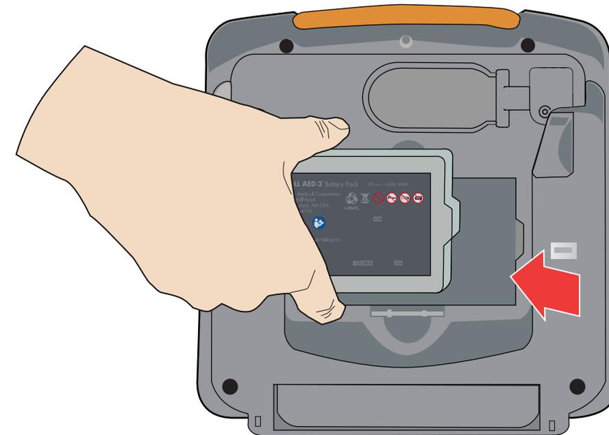
Retirez la pile AED 3 du conteneur de transport. Maintenez la pile par les languettes latérales avec l'étiquette dirigée vers l'avant. Insérez la pile à l'arrière du DA jusqu'à ce qu'elle se mette en place en alignant l'onglet situé à l'extrémité de la pile avec l'encoche correspondante dans le compartiment de pile.
