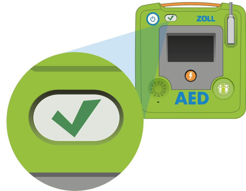
Au terme de l'auto-test de l'AED 3, vérifiez la réussite du test en écoutant le message sonore "Appareil prêt" ou en identifiant l'icône de coche verte dans la fenêtre d'indicateur d'état. Votre AED 3 est prêt à l'utilisation. Si vous avez des questions, consultez le manuel utilisateur inclus dans le dossier de documentation.
